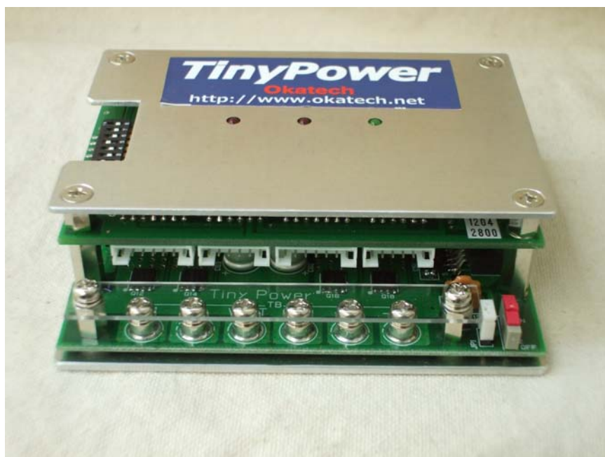
図 3. 1. 2 電源・大型モータ接続端子
